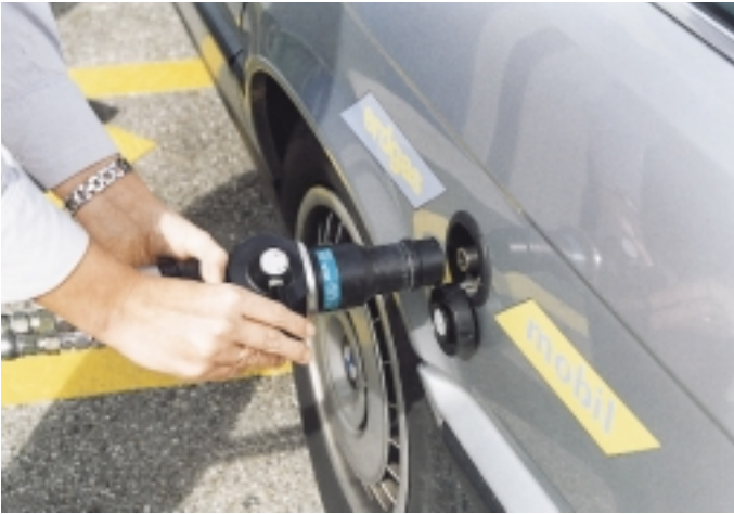
Abb. 2: - Füllhebelstellung „3 Uhr“ – Fülladapter wird auf Fahrzeugbetankungsniessel aufgesetzt
