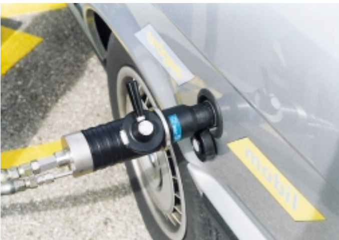
Abb. 4: - Füllhebelstellung „9 Uhr“ – Fahrzeugbetankung läuft
