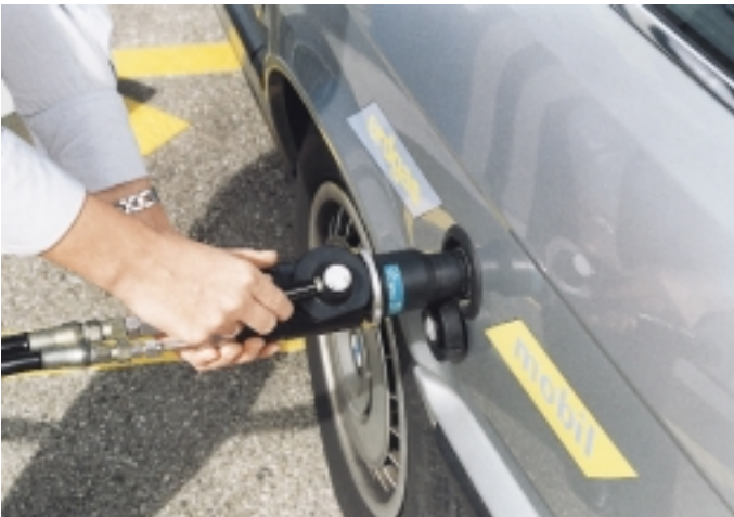
Abb. 3: - Füllhebelstellung „6 Uhr“ – Füllkupplung schließt sich gasdicht an
